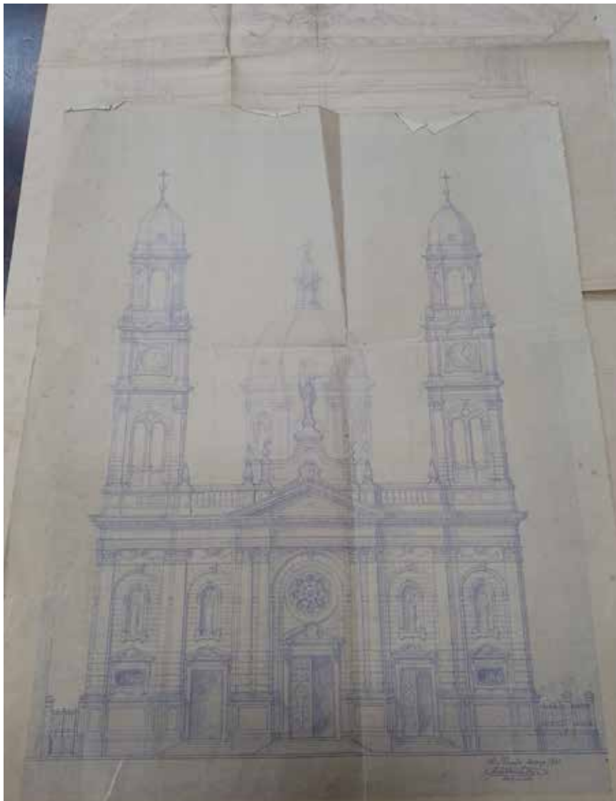
Figura 89 e 90: Cópias heliográficas dos desenhos originais do Giuseppe, onde se percebe um aumento da fachada para comportar o embasamento das duas torres adicionadas. Fonte: Arquivo da Cúria.
