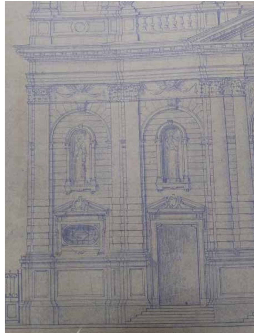
Figura 89 e 90: Cópias heliográficas dos desenhos originais do Giuseppe, onde se percebe um aumento da fachada para comportar o embasamento das duas torres adicionadas. Fonte: Arquivo da Cúria.
